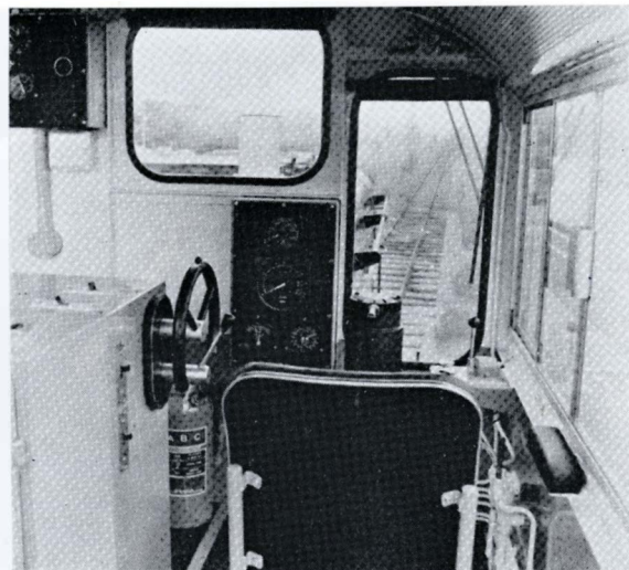
Der er fint udsyn fra førerens plads og han mærker ikke meget mere til varmen end danske kolleger, for førerrummet har tagisolering, rullepersiener i vinduer, tagventilator, vifte og luftfornyelsesanlæg.
